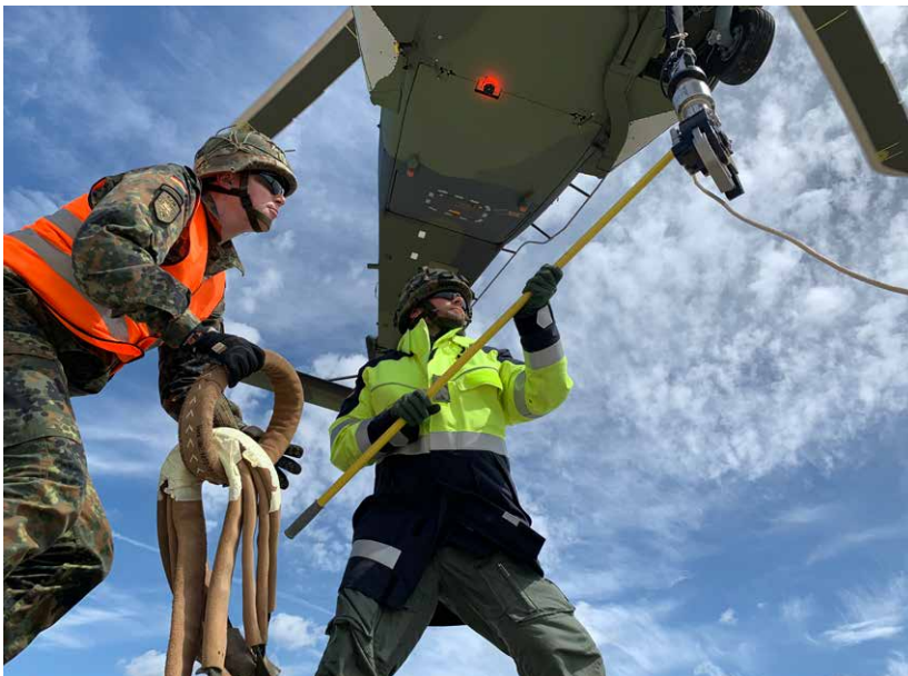
Erdung und Einhängen der Außenlast „Bell UH-1D“
